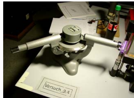
Abb.: Spektrometer mit Balmer-Lampe
