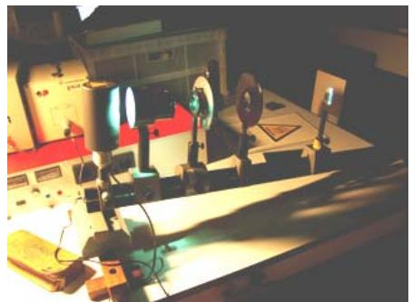
durch die Linse auf dem Schirm im Abstand  $s$  zum Gitter scharf abgebildet. Das Gitter ist parallel zum Schirm ausgerichtet und wird durch die Abstände zwischen 0. und 1. Ordnung sowie 0. und -1. Ordnung verglichen und kontrolliert. Dabei ist darauf zu achten, dass die beiden gelben nebeneinanderliegenden Hg-Linien getrennt voneinander zu erkennen sind.
